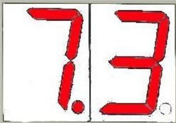
**F** Pendant le fonctionnement, la valeur du pH lu sera visible sur l'afficheur. Le fonctionnement de la pompe est proportionnel, avec un cycle d'arrêt-marche en secondes.
