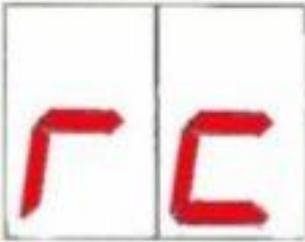
**F** Si à la fin de la calibration l'afficheur indique "rc", appuyer sur CAL pour sortir et retourner à la lecture du pH. Répéter la procédure. Si après une seconde tentative il apparait encore "rc", la sonde pH est défectueuse et doit être changée.
