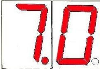
**F** Appuyer sur CAL pendant 3 secondes, la valeur 7.0 va clignoter sur l'afficheur. La calibration pH 7.0 est automatique, se terminant quand la valeur sur l'afficheur devient fixe.
